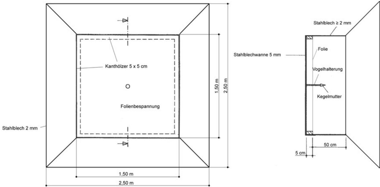
**Abbildung 7.9.6** Geschossfang für Flinten mit Schrot auf Vogelschießständen
