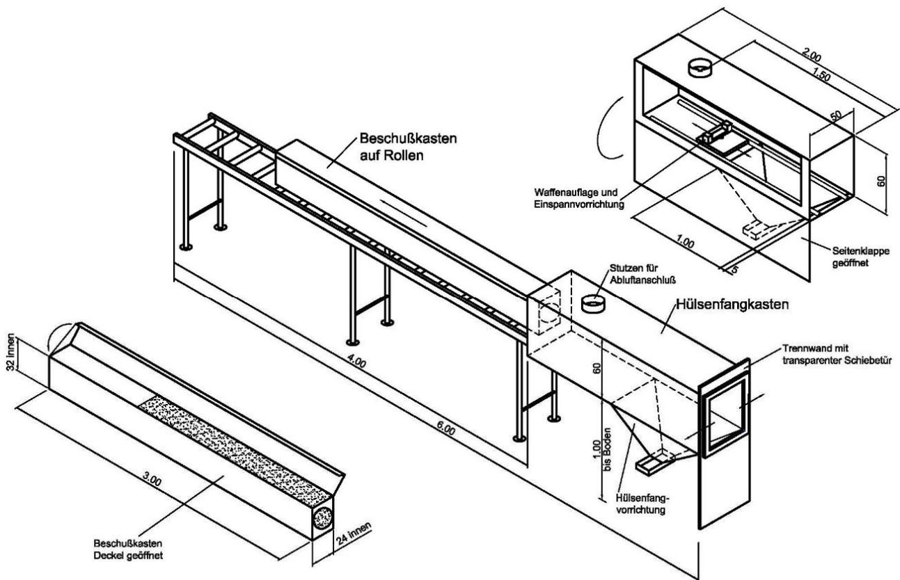
Abbildung 5.6.3.7.3 Wattebeschusskasten
