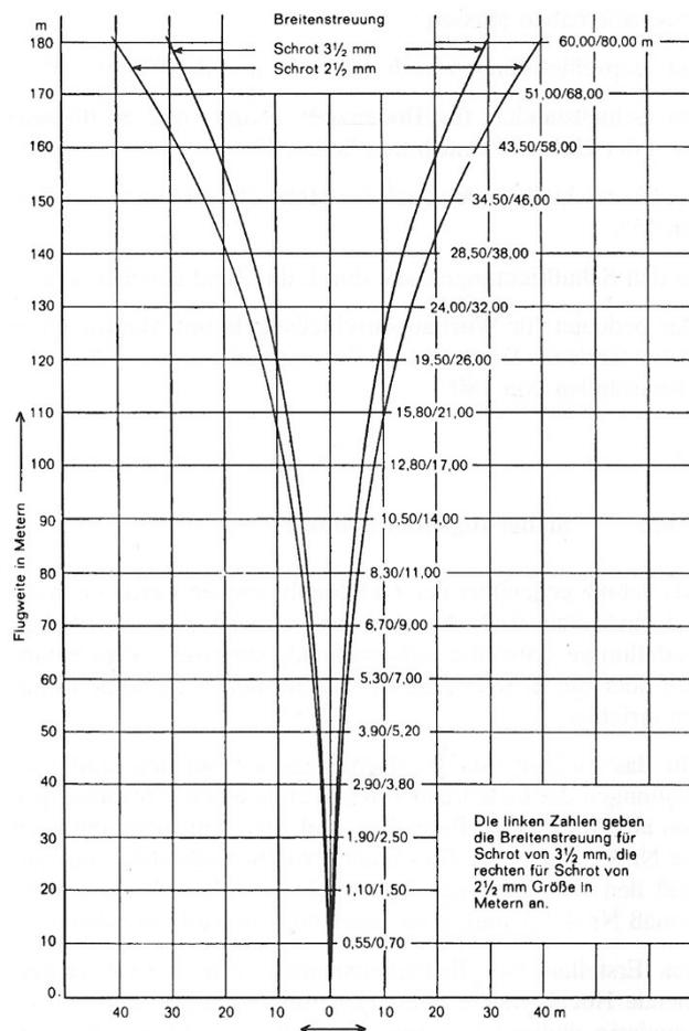
**Abbildung 9.2.1** Durchmesser und Breitenstreuung von frei fliegenden Schroten
