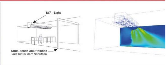
Strulik SVA-Light – Modul zur Erzeugung einer lokalen Verdrängungslüftung direkt am Schützen mit dem Hauptschützziel „Abfuhr von schädlichen Gasen vom Schützen“ (Ersparnis Volumenstrom und Gesamtinvestition-Lüftung bis zu 50%)
