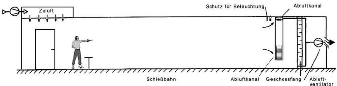
Abbildung 5.7.2.2.2 Verdrängungslüftung mit Zuluftfeinbringung über die Raumdecke sowie mit obenliegender und seitlicher Absaugung
