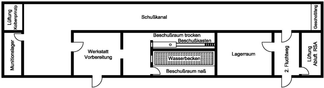
Abbildung 5.6.3.7.1 Beispielhafte Anordnung von Prüf- und Messräumen
