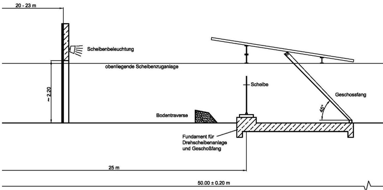
Abbildung 4.3.3 Nach unten ausschwenkbares Geschossfangsystem
