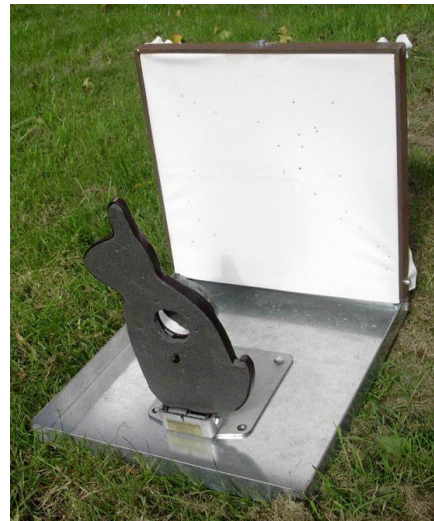
Abbildung 6.4.6.2 Seitenansicht eines Field-Target-Geschossfanges
